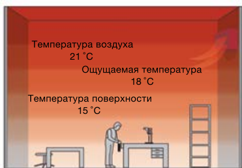
Температура воздуха и ощущаемая температура при использовании систем воздушного отопления.
