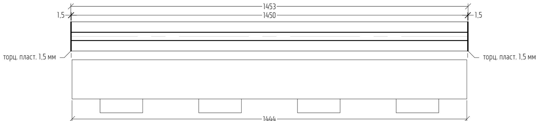
**Модульный диффузор от 3000 мм**
