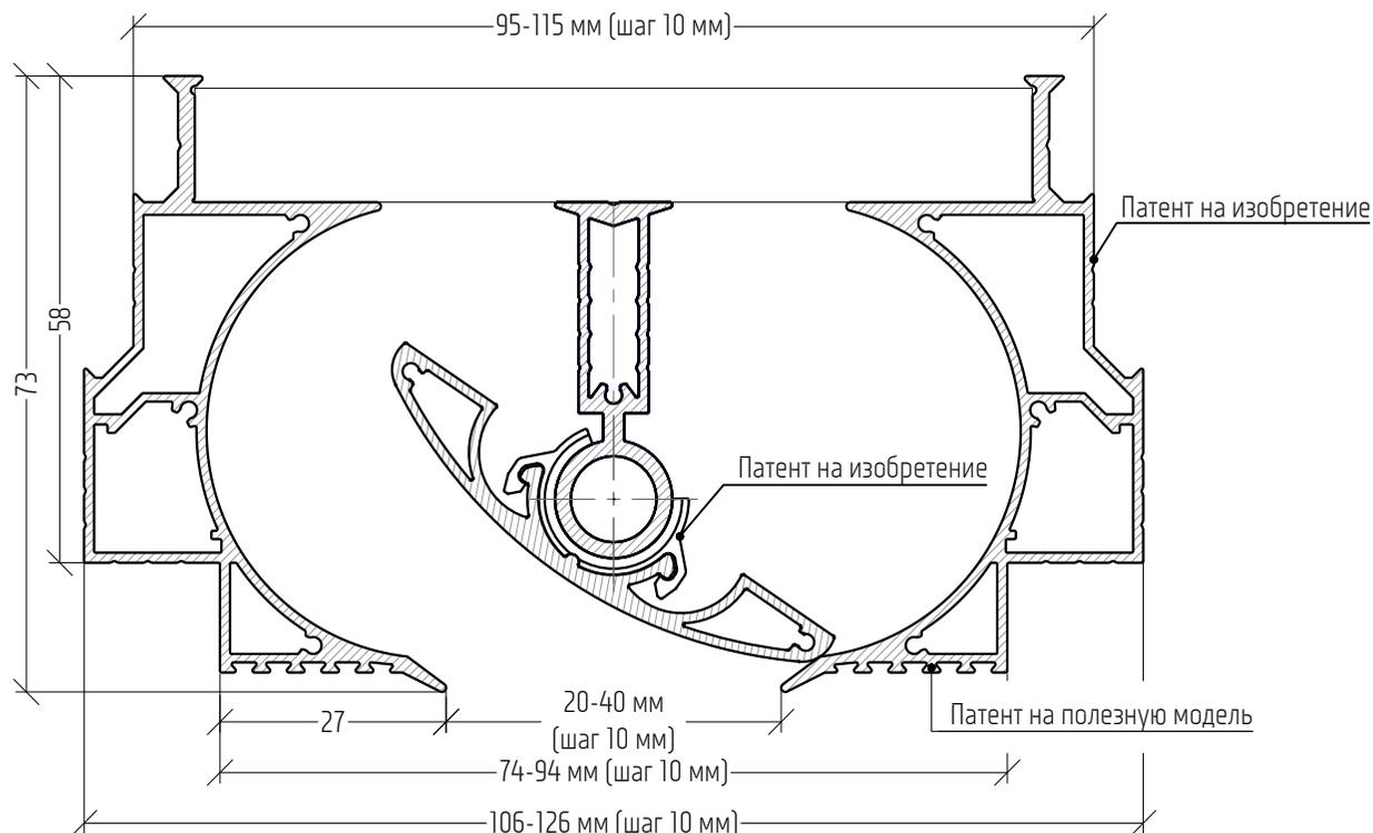
Схема комплекта диффузор + КСД
