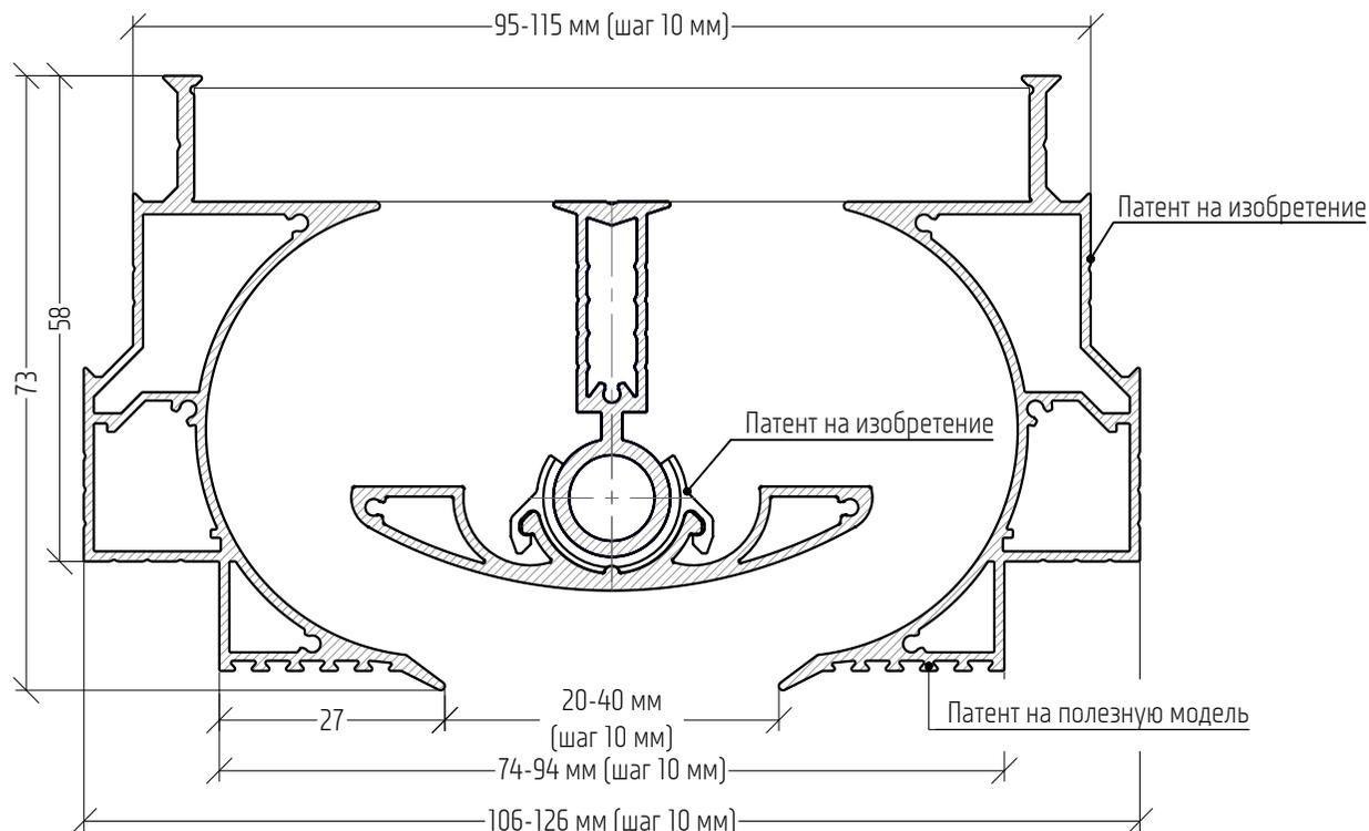
Схема комплекта диффузор + КСД
