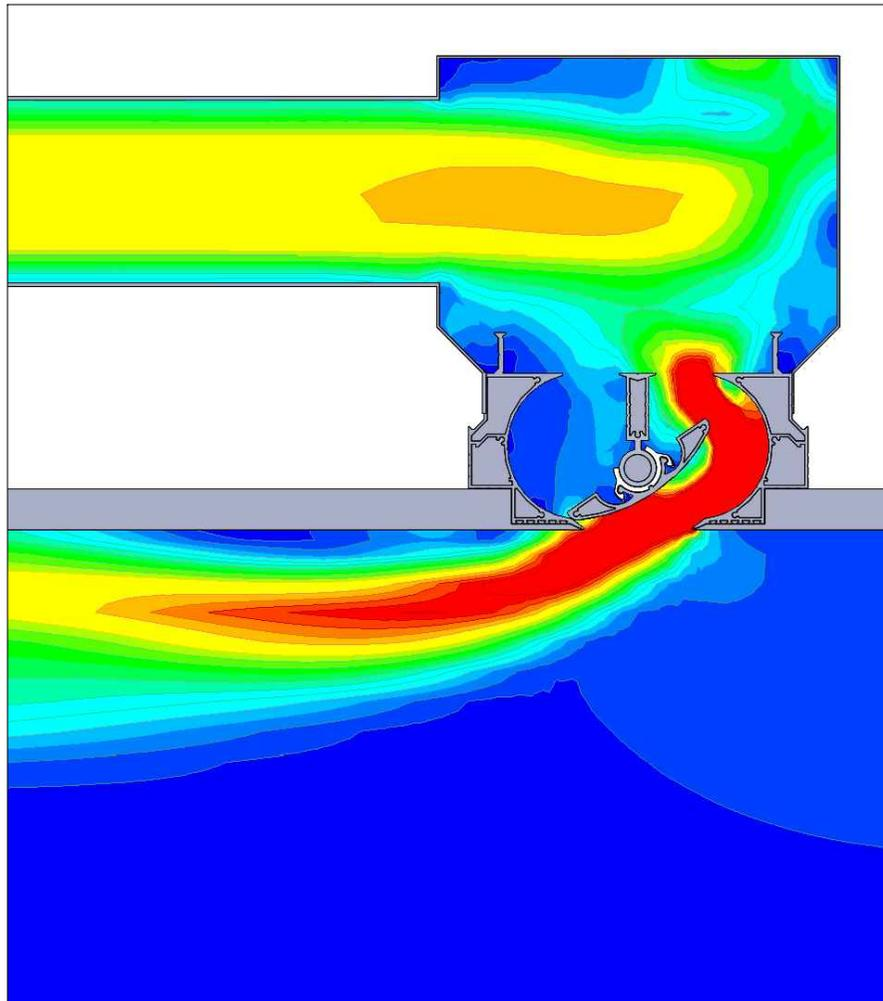
Профиль перепада давления в поперечном сечении диффузора
