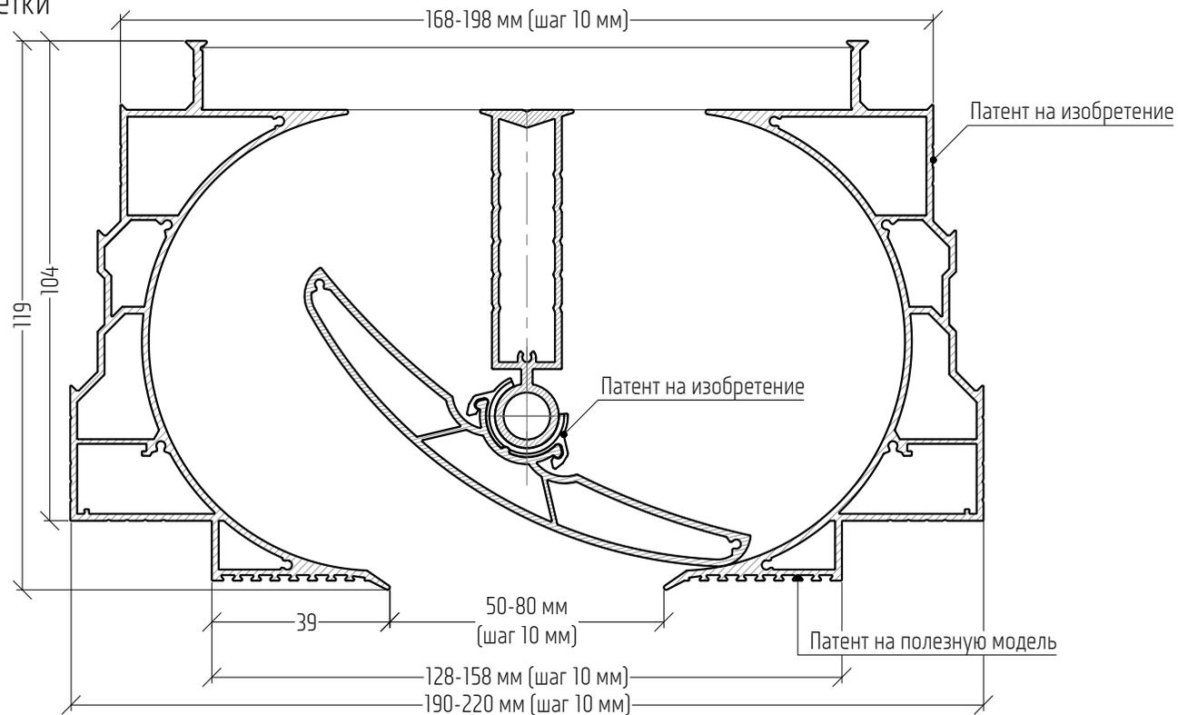
Схема комплекта диффузор + КСД
