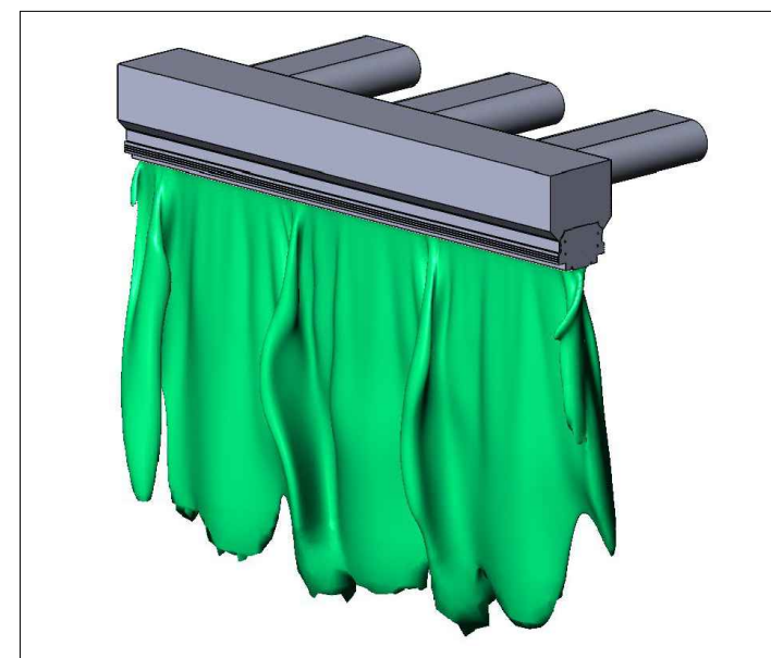
Изоповерхность скорости 0,6 м/с AESTHETIC+BOX-STD
